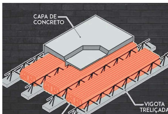
Laje em estrutura de concreto preenchida com lajotas cerâmicas.
